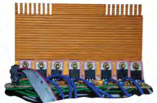
Transistoren aan de gezamenlijke kathode
