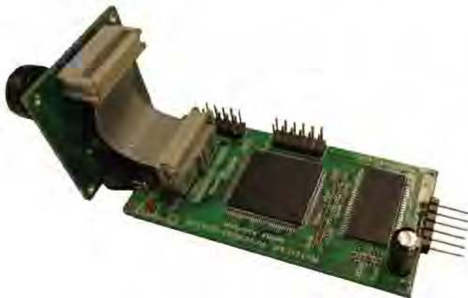
Figuur 1: Eén van de ontworpen modules. De FPGA en het geheugen zijn duidelijk te zien. Op de verticale PCB bevindt zich de beeldsensor met de lens.
