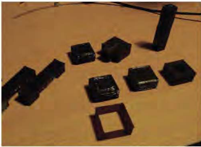
Figuur 11: Een aantal testobjecten op parameters in skeinforge te bepalen.
