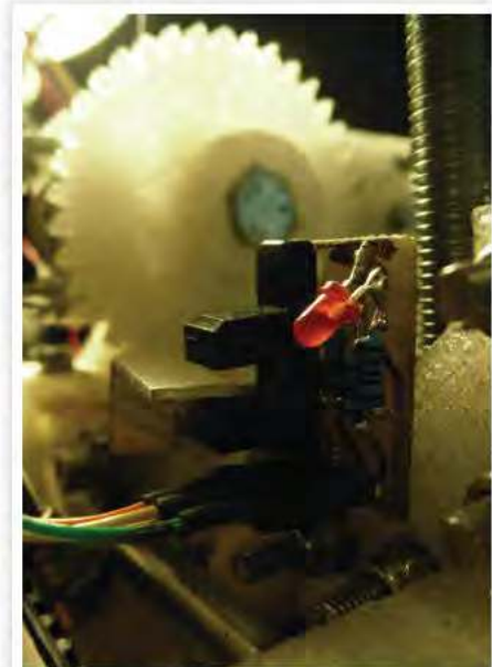
Figuur 6: Opto-endstop van de x-as
