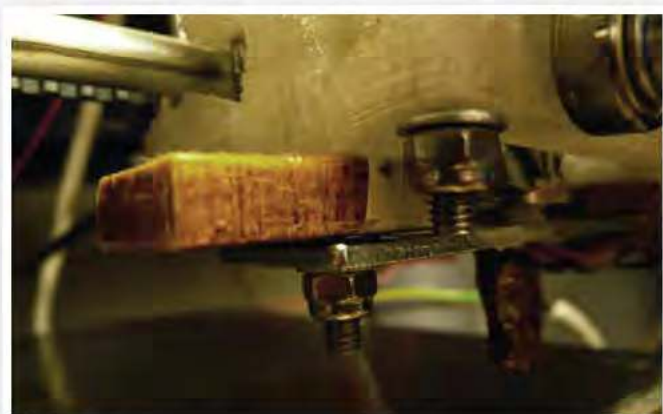
Figuur 8: De connectie tussen de hot end en het wagentje.
