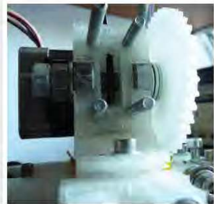
Figuur 3: De extruder met het feedmechanisme die het plastic naar de printkop duwt.
